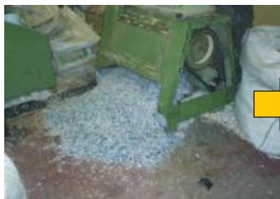
Habilitación de materia prima por medio de triturado y/o densificado.
